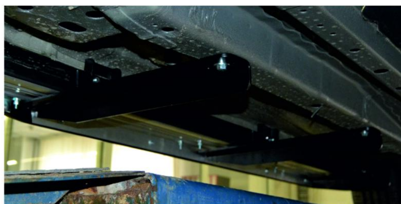
Рис. 2а - Установка передних кронштейнов
