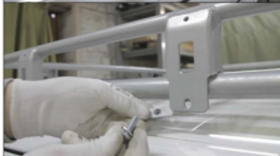
38. Закрепить верхний ярус(поз.2) к нижнему ярус(поз.1) винтами M8x20(поз.10), шайбами(поз.13) и закладными(поз.6). Протянуть все резьбовые соединения.
