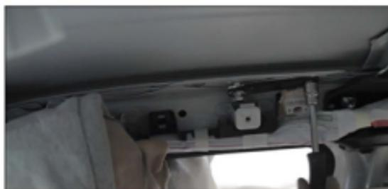
31. Закрепить опоры(поз.7) болтами М8х25(поз.9), шайбами(поз.13) и внутренними пластинами(поз.8) через просверленные отверстия.
