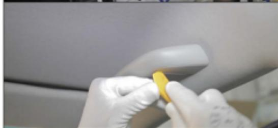
3. Демонтировать ручки с потолка автомобиля.
