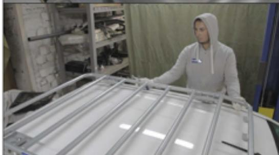
36. Отрегулировать багажник, протянуть все резьбовые соединения.
