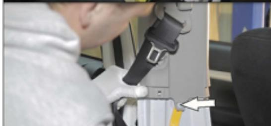
9. Отщелкнуть пистоны крепления верхних накладок на центральных стойках автомобиля. Сдвинуть накладки вниз.
