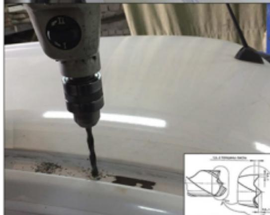
26. Просверлить отверстия в крыше диаметром 8-8,5мм. Во время сверления со стороны салона рекомендуется подложить металлическую пластину, для избежания повреждения подушки безопасности.
