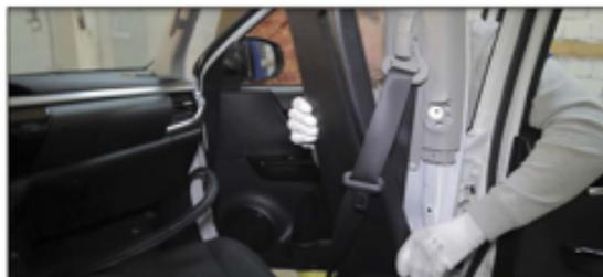
8. Демонтировать нижние накладки на центральных стойках автомобиля.
