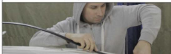
32. Установить пластиковые наклейки в желоб крыши, предварительно подрезав их в месте установки опор.
