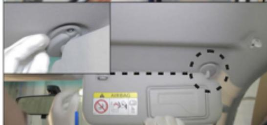
10. Демонтировать пластиковую заглушку, закрывающую винты крепления солнцезащитных козырьков.
